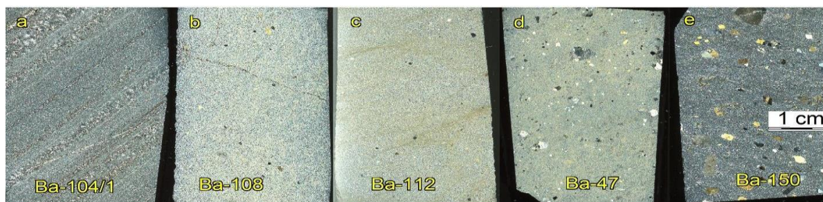
Рис. 5. Шлифы риодацитов нижней толщи. Основная масса криптомикроструктурная. Фенокристы (от 0,4 до 10 мм) идиоморфные, не превышают 10% от объема породы, представлены кварцем, полевым шпатом в соотношении 1: 1.
